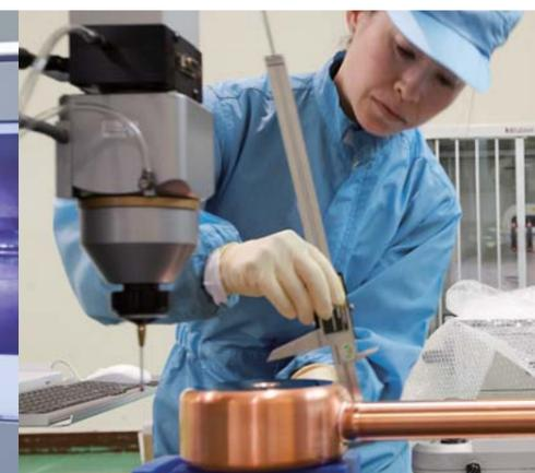
三次元計測器により、詳細に寸法がチェックされる「陽子加速器」の構成部品。精密加工・精密組立が求められる「常伝導加速器」の部品製造では、ほぼ全部品に対して三次元計測を実施し、厳正な出荷判定を行う。
