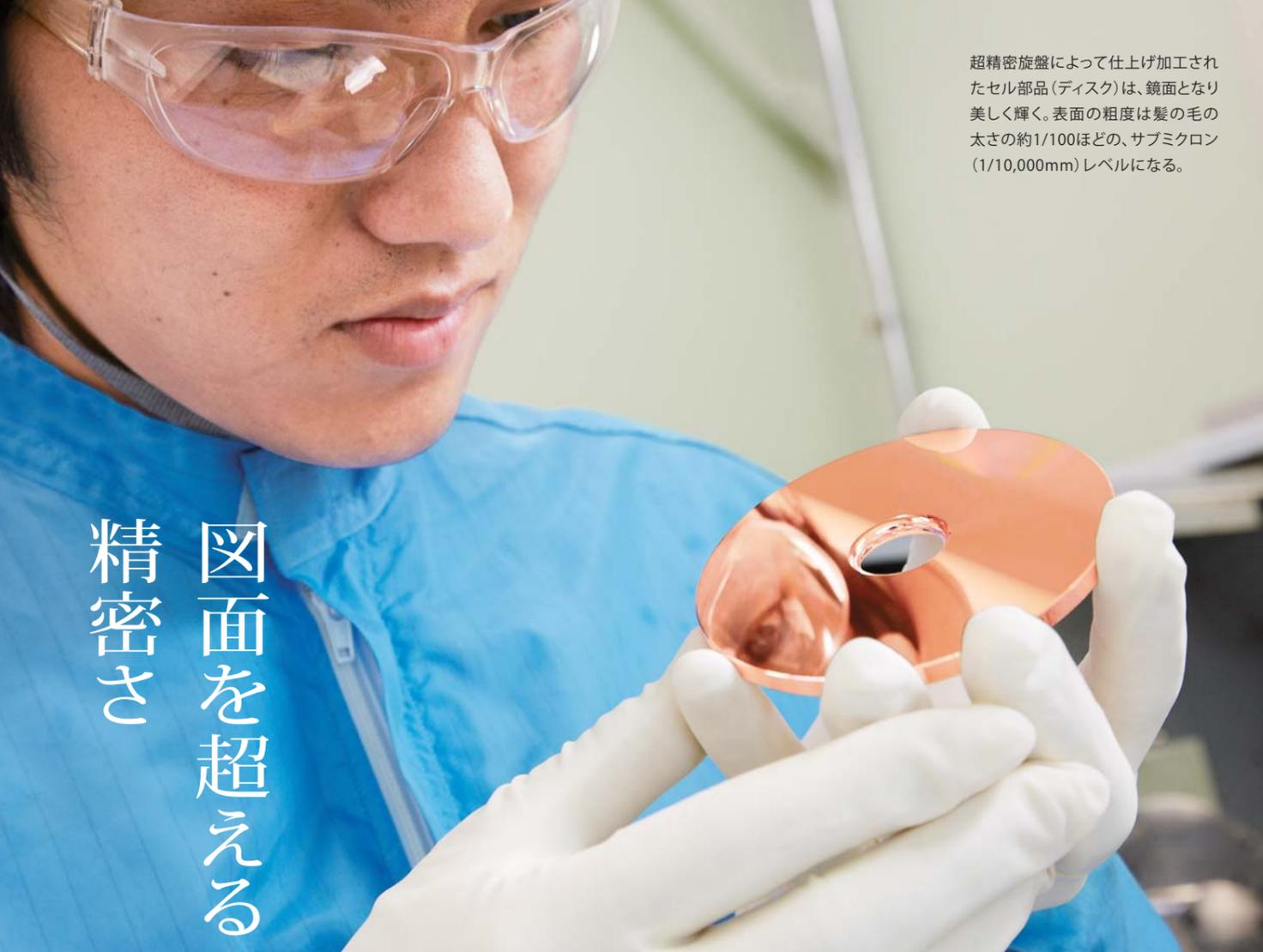
超精密旋盤によって仕上げ加工されたセル部品(ディスク)は、鏡面となり美しく輝く。表面の粗度は髪の毛の太さの約1/100ほどの、サブミクロン(1/10,000mm)レベルになる。
