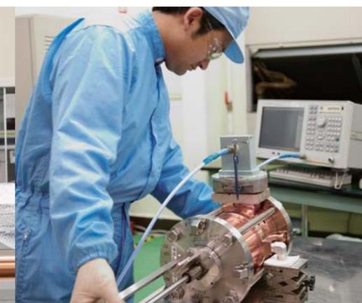
加速管内へ大出力の高周波を投入する「カブラー部」の共振周波数が、高周波測定装置を用いて計測される。わずかでも周波数の誤差がある場合には超精密旋盤を使い、ミクロン単位で修正加工を施す。規定の周波数になるまで、チューニングと修正加工が繰り返される。
