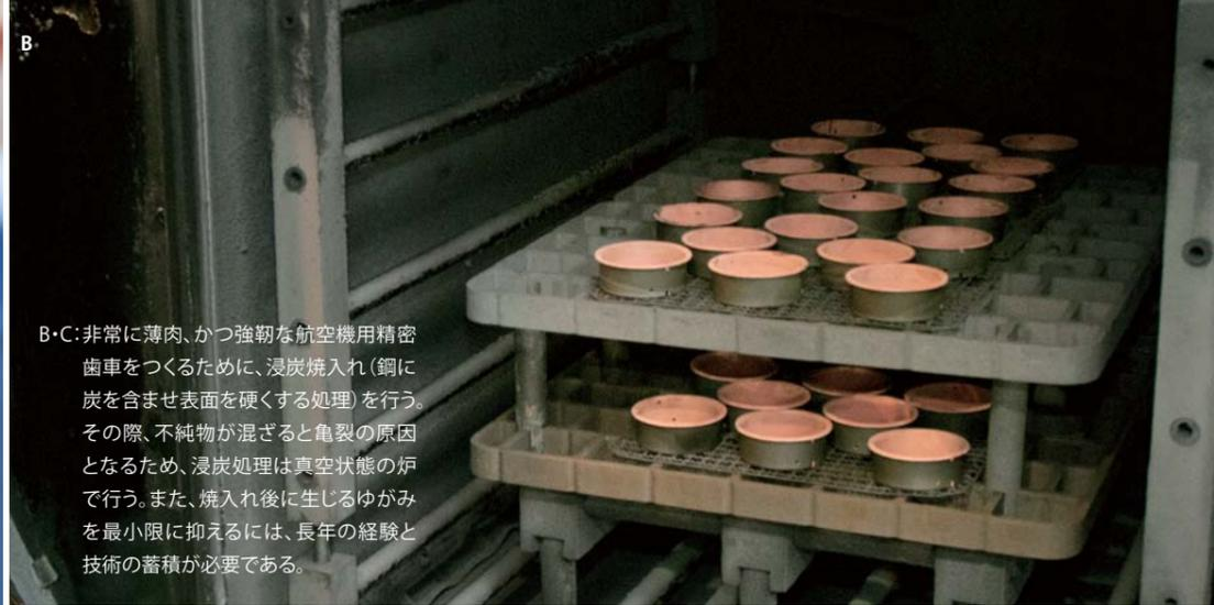
B・C: 非常に薄肉、かつ強靱な航空機用精密歯車をつくるために、浸炭焼入れ(鋼に炭を含ませ表面を硬くする処理)を行う。その際、不純物が混ざると亀裂の原因となるため、浸炭処理は真空状態の炉で行う。また、焼入れ後に生じるゆがみを最小限に抑えるには、長年の経験と技術の蓄積が必要である。
