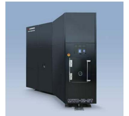
2012年に開発された3次元集積化LSI用常温ウェーハ接合装置「BOND MEISTER MWB-12-ST」。LSI用で主流の300mm大口径ウェーハを立体的に積層できる、常温接合装置の製品化は世界初。
