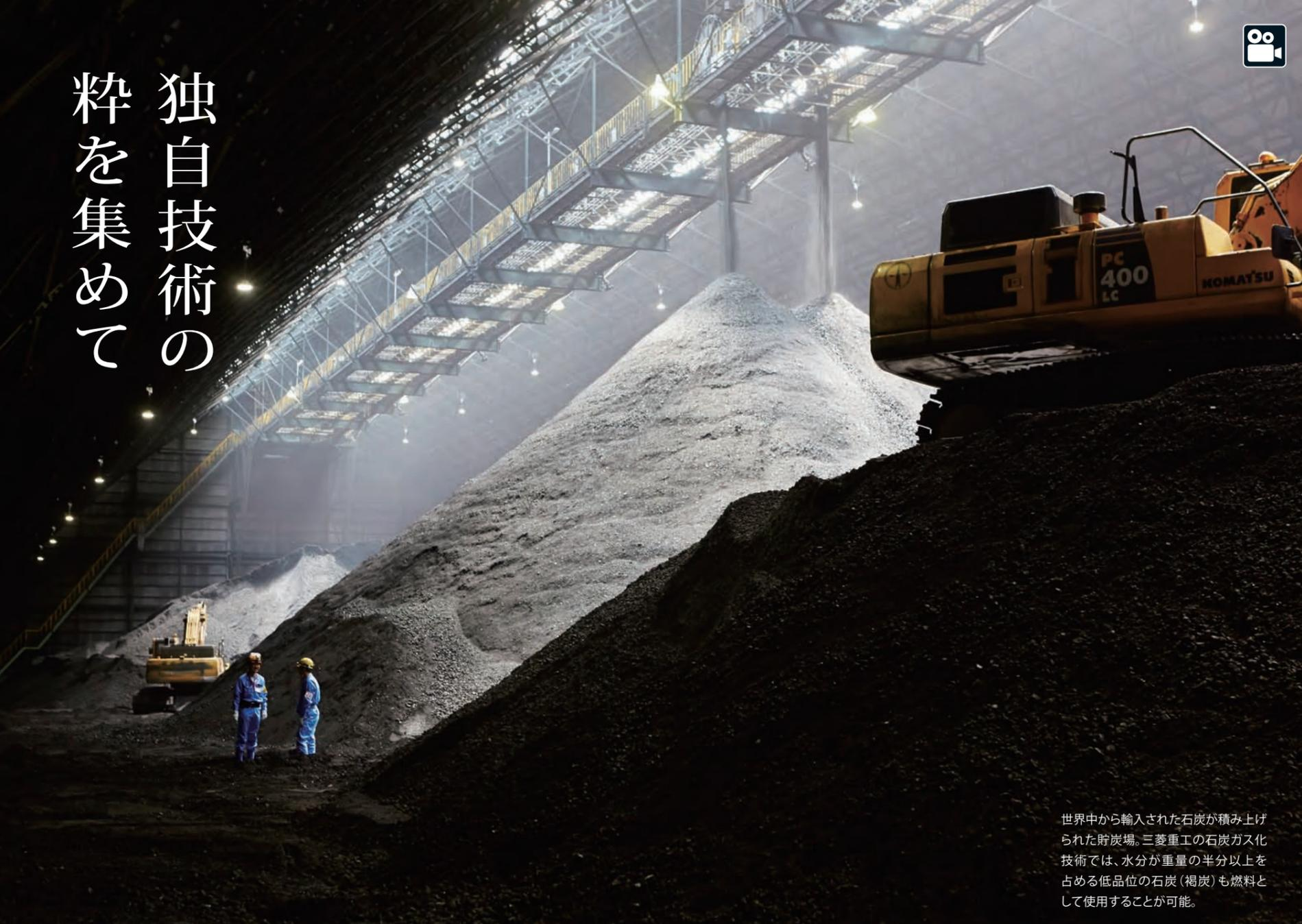
世界中から輸入された石炭が積み上げられた貯炭場。三菱重工の石炭ガス化技術では、水分が重量の半分以上を占める低品位の石炭（褐炭）も燃料として使用することが可能。
