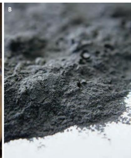
A・B: 石炭を微粉炭機で約0.1mm以下にまで細かく砕く(写真A)。砕かれた石炭は表面積が大きくなり、より効率よく燃えるようになる(写真B)。
