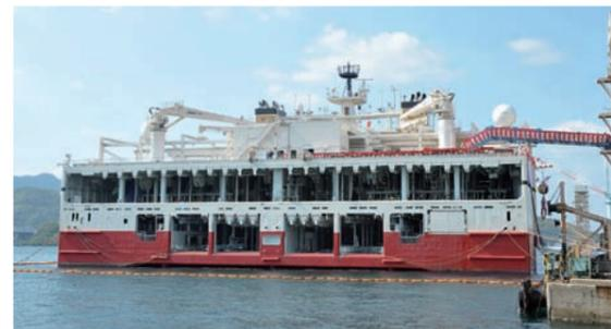
RAMFORM TITANの船尾部。船尾のストリーマーデッキには24本ものストリーマー・ケーブルを搭載することができる。
