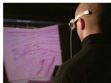
複数のセンサーにて受信したデータの解析により、海底構造を3Dで抽出できる。
