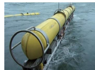
これらのエアガンから衝撃波を発生し、海底面などからの反射波をセンサーにて受信する。
