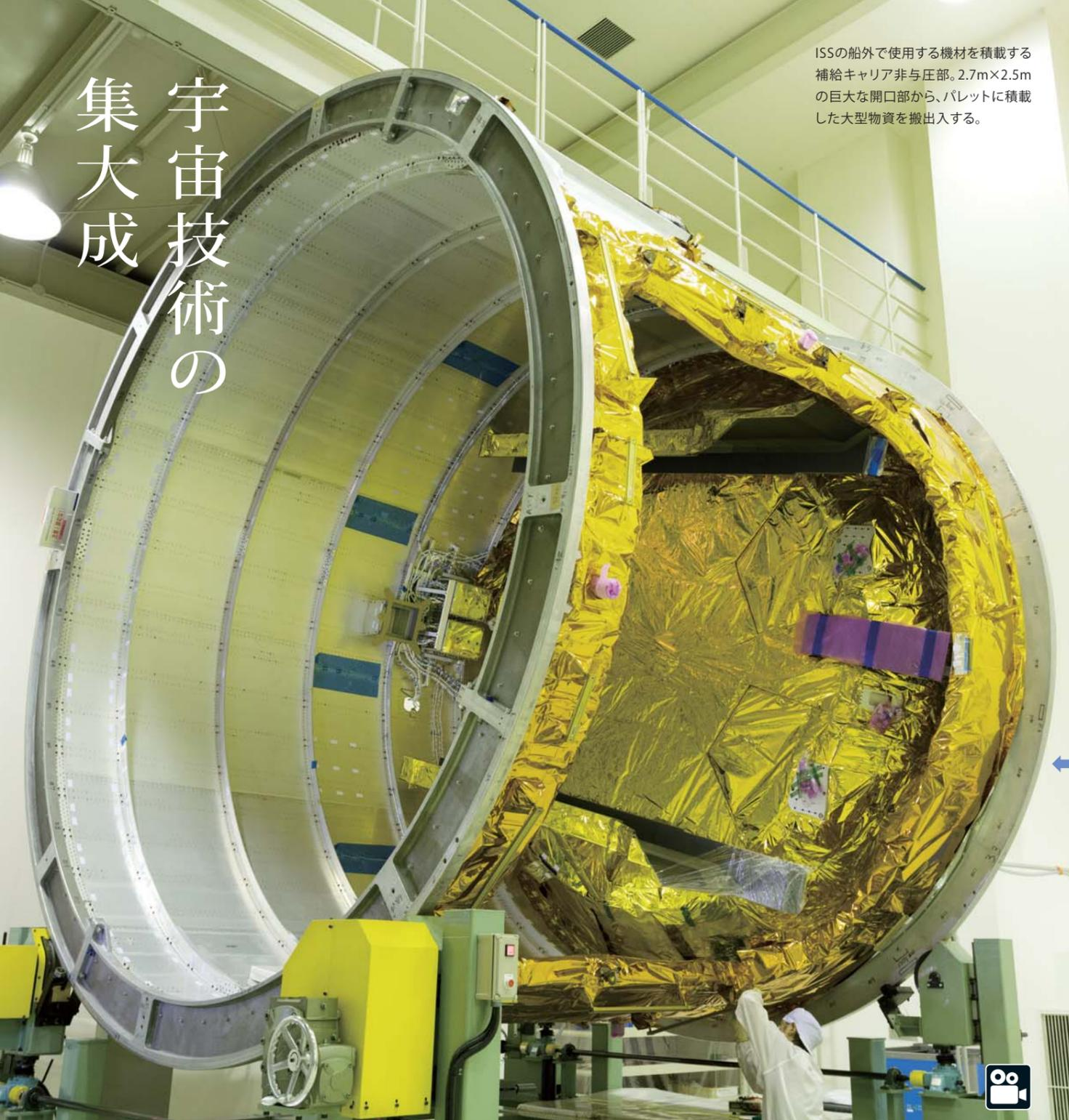
ISSの船外で使用する機材を積載する補給キャリア非与圧部。2.7m×2.5mの巨大な開口部から、パレットに積載した大型物資を搬出入する。
