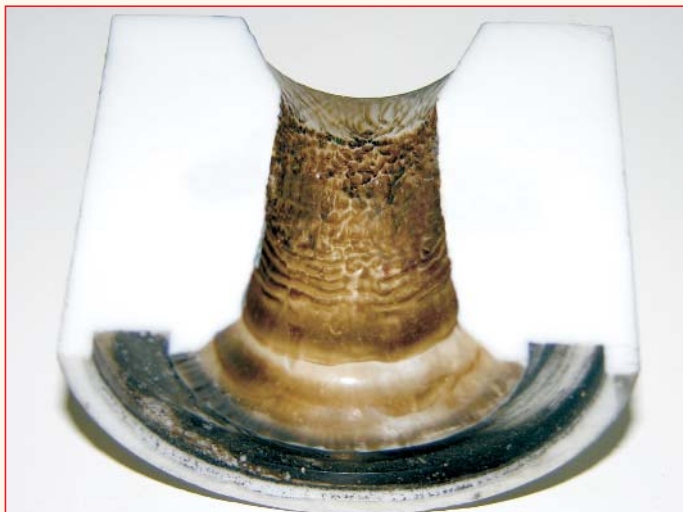
Рис. 2 Фото волн Толмина-Шлихтинга в трансзвуковой части сверхзвукового конического сопла
