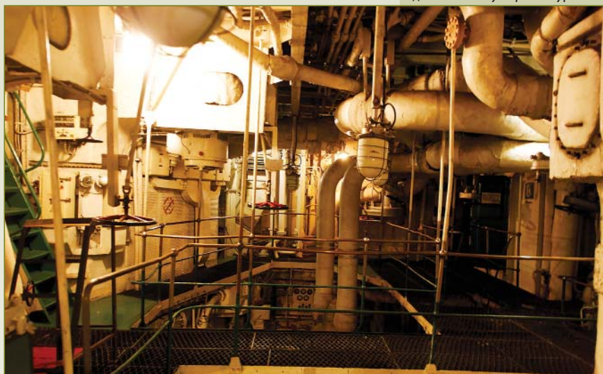
Паропроводы машинного отделения. Внизу паровая турбина
