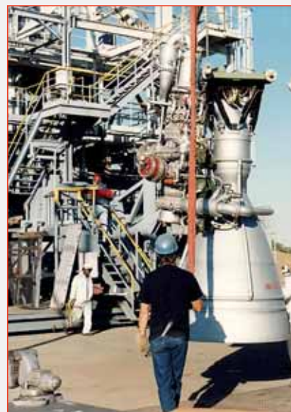
Подготовка НК-33 к испытаниям
