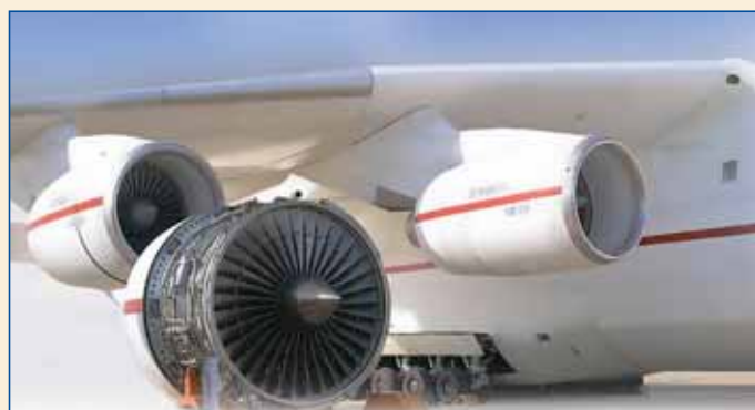
Двигатель Д-18Т на фоне самолёта Ан-124 "Руслан"
