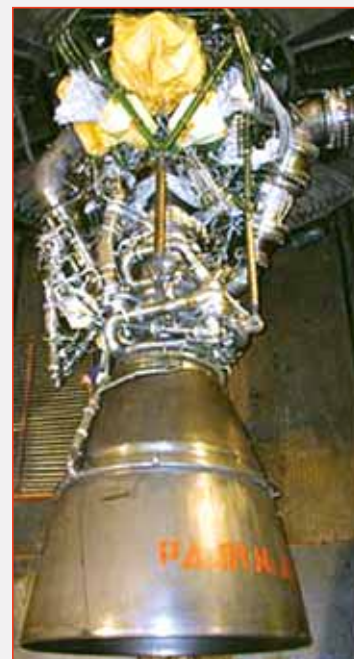
ЖРД РД 191 на стенде НПО Энергомаш
