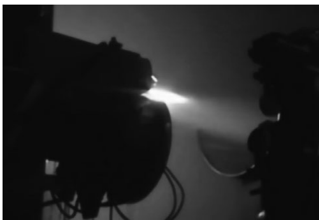
図13 水プラズマトラックに搭載された200 kWの水プラズマ発生の様子。下部の円板が陽極であり、水プラズマは左から右に発生している。
