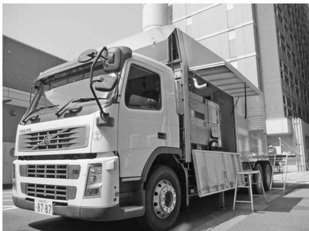
図12 200 kWの水プラズマシステムを搭載したプラズマトラック (株式会社 HELIX 提供)。
