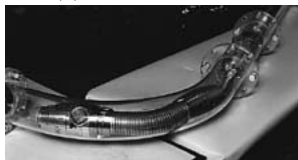
(b) 曲がり管内通過状況(母管外径: 100 mm, 曲げ半径: 400 mm)
