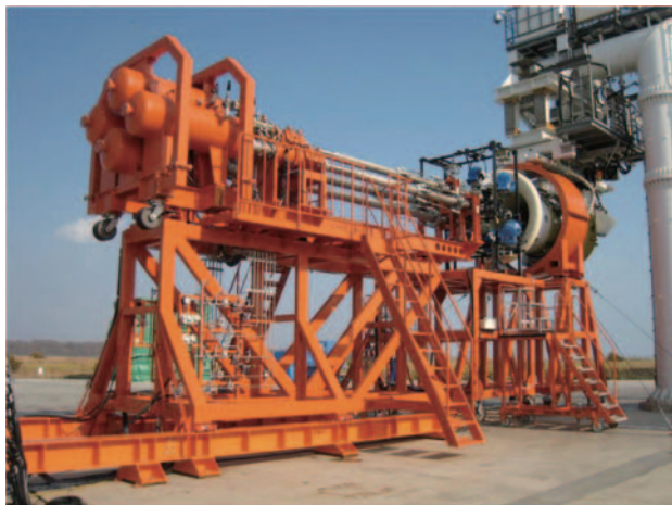
図17 鳥吸込み試験用器材（砲身4門）
