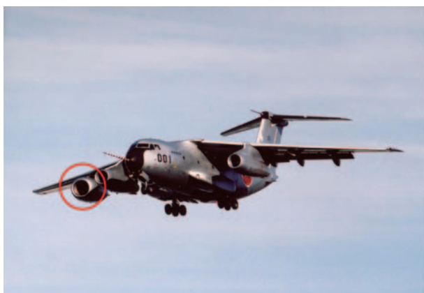
図20 C-1FTB機に搭載されたXF7-10 (PFRT) エンジン
