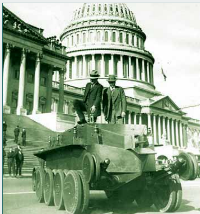
Первый колесно-гусеничный танк "Кристи" M1919
