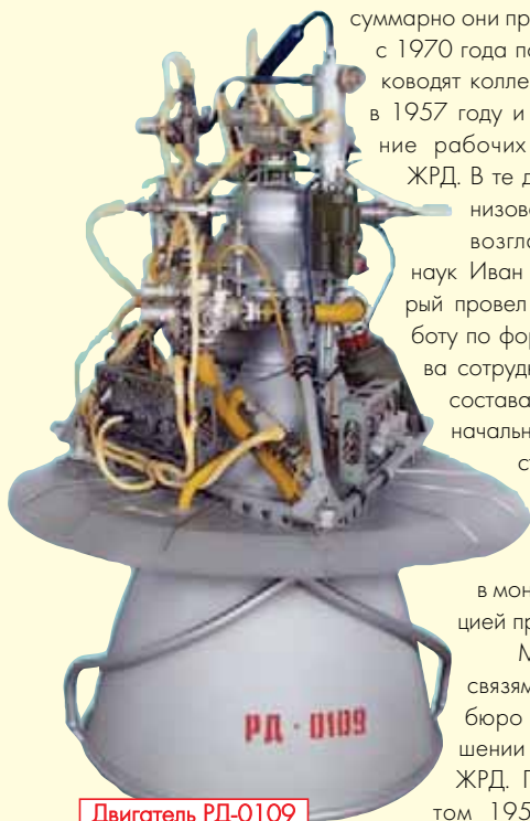
Двигатель РД-0109 (РО-7) третьей ступени ракеты "Восток"
