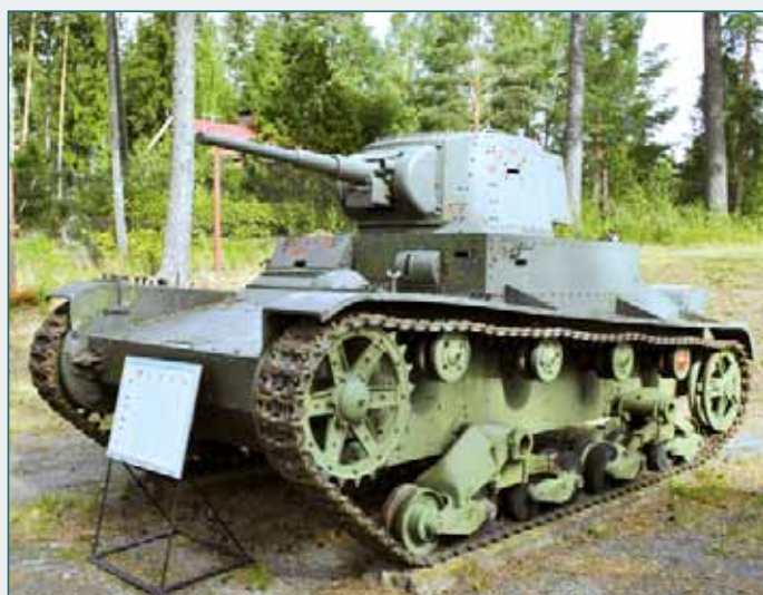
Английский Vickers Mk.E mod.B - легкий танк огневой поддержки, однобашенный вариант. Корпус - клепаный коробчатого сечения. Механик-водитель располагается в передней части корпуса справа. Башня конической формы размещена на подбашенной коробке ближе к левому борту. Вооружение - 47-мм пушка и 7,7-мм пулемет в спаренной установке. Боекомплект 50 выстрелов и 4 тыс. патронов. Бронирование - 5...13 мм. Двигатель - Armstrong Siddeley, 4-цилиндровый, карбюраторный, воздушного охлаждения.
