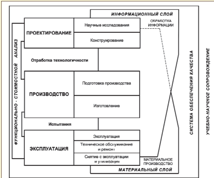
Рис. 2 Системы обеспечения и сопровождения стадий жизненного цикла сложных технических объектов
