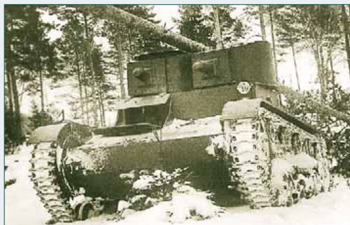
Vickers Mk.E mod.A - двухбашенный вариант, танк сопровождения пехоты. Башни цилиндрической формы размещены рядом на подбашенной коробке. Вооружение - два пулемета Vickers калибра 7,7 мм. Горизонтальный обстрел для каждого пулемета в башнях составляет 265°. Боекомплект - 6 тыс. патронов
