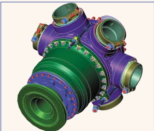
Расчётные модели элементов конструкторов в нагруженном состоянии, рассчитанные на ЭВМ
