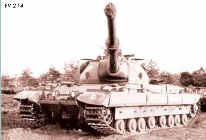
Корпус имел лобовую броню 130 мм под углом 60°, в связи с чем приведённая броня в лобовой проекции достигала 260 мм. Броня бортов и кормы составляла 51 мм. Дополнительно по бортам устанавливались 6-мм противокумулятивные экраны.
