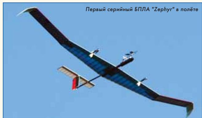
тор PS001. Такие БПЛА обеспечивают как длительное нахождение в воздухе, так и возможность постоянного нахождения над определённым местом в отличие от спутника, который может повторно пролететь над одной и той же точкой только через 24 часа. Полеты осуществляются на таких высотах, на которых на него не влияют погодные условия и полеты коммерческой авиации. Стоимость запуска БПЛА данного класса существенно ниже вывода на орбиту спутника.
