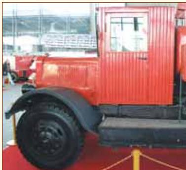
Почти все узлы трансмиссии и шасси были тяжелыми и металлоёмкими. Из-за этого ЯГ-6 весил 4940 кг, а его грузоподъемность составляла пять тонн. Двигал такого монстра силовой агрегат мощностью всего 73 л.с. со скоростью не более 40 км/ч. Рулевое управ-
