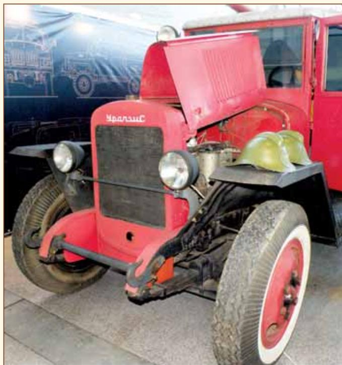
Боевой расчёт составлял 6 человек. Ёмкость цистерны для воды составляла 1420 литров, бака для пенообразователя - 80 литров. Подача воды осуществлялась насосом ПН-25А. Кузов пожарной автоцистерны был закрытого типа, а цистерна для воды имела систему обогрева отработанными газами.
