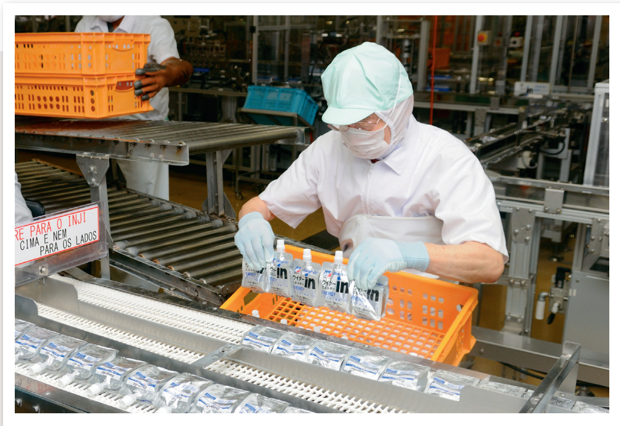
秋田屋本店の洞戸工場で森永製菓の「ウイダーinゼリー」を受託生産する様子。多品種を柔軟に生産するため、一部で手作業を取り入れているライン。改善活動で25人以上を省人化した
