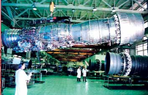
Двигатель Д-30Ф6 для лучшего в мире истребителя-перехватчика МиГ-31 и высотного дозвукового самолета М-55 "Геофизика"
