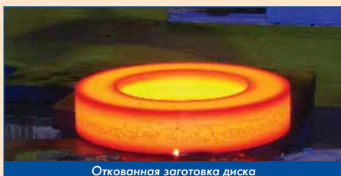
Откованная заготовка диска
