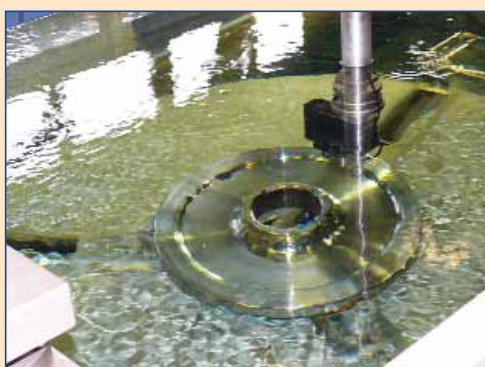
Ультразвуковая дефектоскопия заготовки диска турбины
