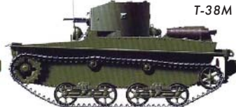
Вид сбоку. Видны отличия в высоте корпуса и конструкции тележек
