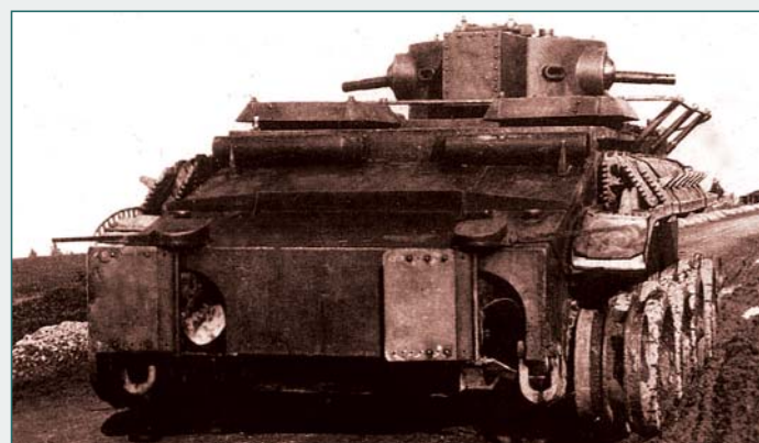
Вид сзади танка ПТ-1. Видны тоннели с гребными винтами
