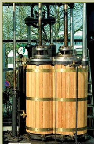
Двухцилиндровая компаунд-машина А. Вульфа, построенная в 1858 году. Цилиндры расположены вертикально, левый высокого давления, правый (побольше) низкого. В целях снижения потерь тепла, они заключены в деревянные рубашки
