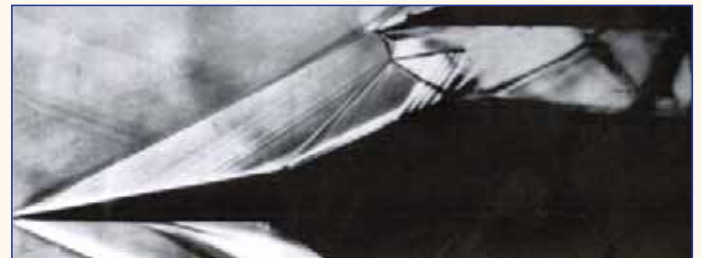
Рис. 4 Маховская интерференция догоняющих скачков [13]
