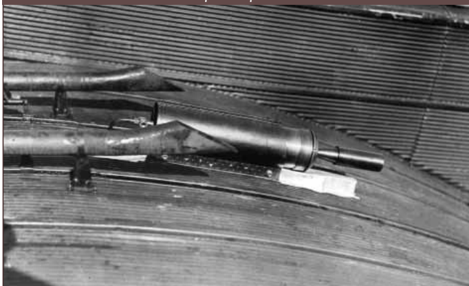
Размещение твердотопливных стартовых ракет на бомбардировщике ТБ-1. Первый вариант
