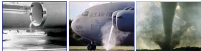
Рис. 4 Фотографии вихревых восходящих потоков на входе в двигатели самолетов ИЛ-86 и американского транспортного - а и б, и торнадо в Америке [9]
