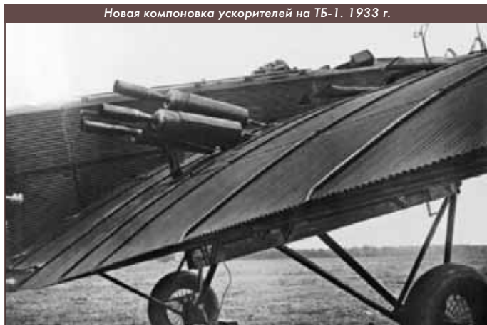
Новая компоновка ускорителей на ТБ-1. 1933 г.
