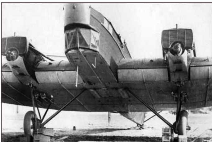
Размещение твердотопливных стартовых ракет на бомбардировщике ТБ-1. Первый вариант
