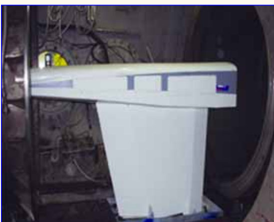
Рис. 3 Испытания на стенде Ц-16ВК по теме ВГС в рамках проекта Hexafly-Int
