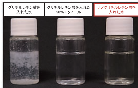
グリチルレチン酸は水に溶解せず、析出する(左)。従来は50%エタノールに溶解していた(中)。「ナノグリチルレチン酸」は、エタノールがなくても水に分散可能である(右)。
