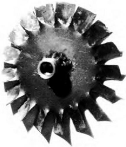
Rys. 6. Wirnik turbiny osiowej mikrosilnika : a) wykonany w technologii uproszczonej b) produkt komercyjny
