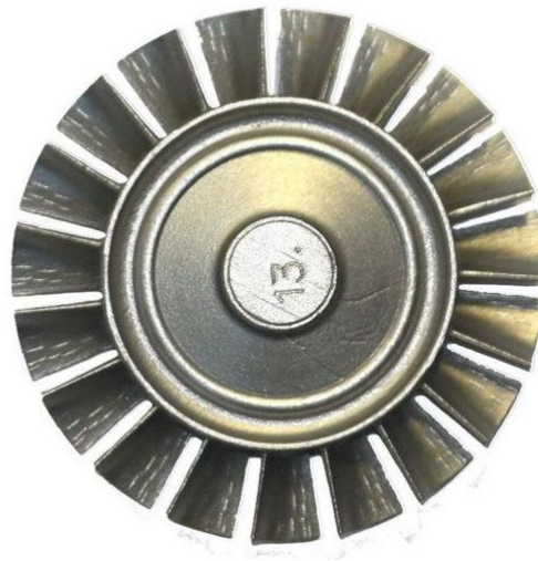
Rys. 6. Wirnik turbiny osiowej mikrosilnika : a) wykonany w technologii uproszczonej b) produkt komercyjny
