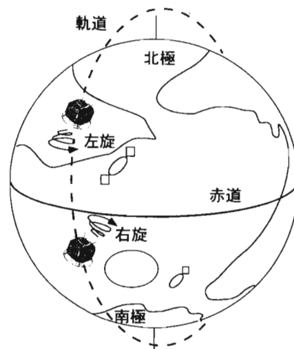
第6図 1軌道中で偏波の回転方向が逆になる例
