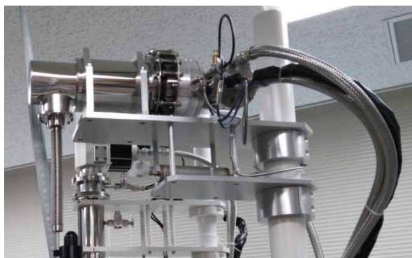
凝縮ユニット
