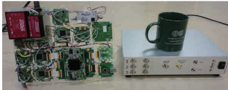
図2 Opencore NMR 分光計の外観。左は基板むき出しタイプ。右はシャーシに入れてコネクタを取り付けたタイプ
