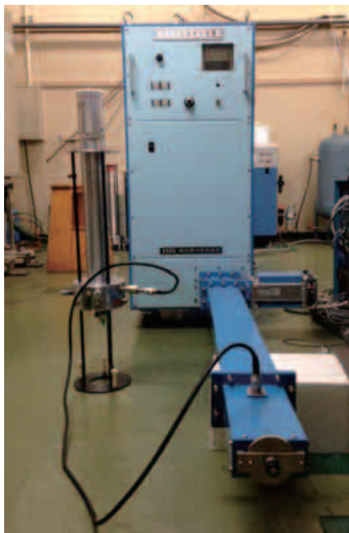
図3 新規固体NMR装置 (左) マイクロ波発生装置 (右) 光照射装置
