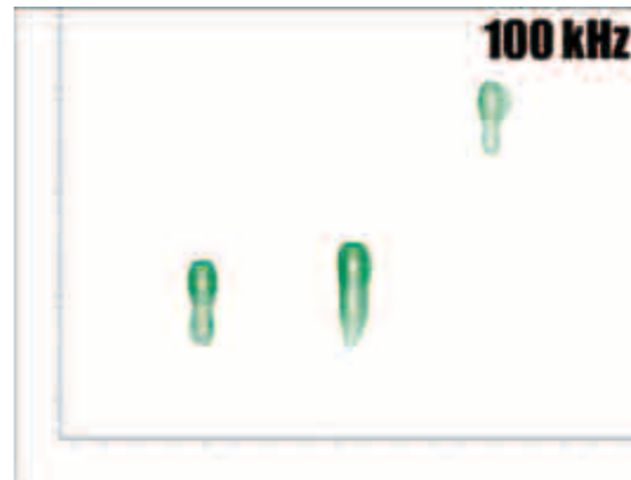
図5 L-Histidine 塩酸塩の ^1\text{H} - ^{14}\text{N} HMQC測定。100 kHzの試料回転のもとで14.1 Tの静磁場で測定した
