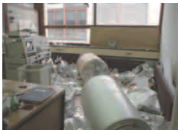
図1 冷媒の閉塞による真空容器の爆発後の実験室手前に見える筒状のものが磁石の内部容器、奥のものが、磁石の外側の部分である。散乱している破片は、断熱材のアルミ蒸着フィルムである。頑丈なアルミダイカスト製の架台が破壊されるほどのエネルギーである。
