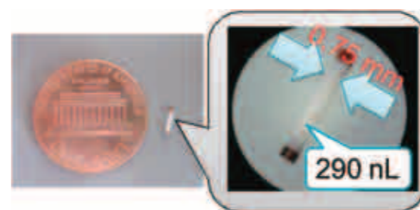
図1 110kHzの超高速回転を可能とする外径0.75mmの試料管
