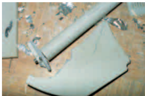
図2 2トン以上の耐荷重を有するベースプレートの爆発による破壊。
