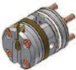
0.75 mm試料管 (容量 0.29  $\mu$ l) で世界最高回転速度110 kHz以上を (2013年9月現在) 実現した0.75 mm CPMASプローブは、マイクロコイルによる微量試料に対する高感度測定その他、強いRF磁場強度と超高速試料回転の効果により、様々な新しい固体NMRの世界を可能にしました。
