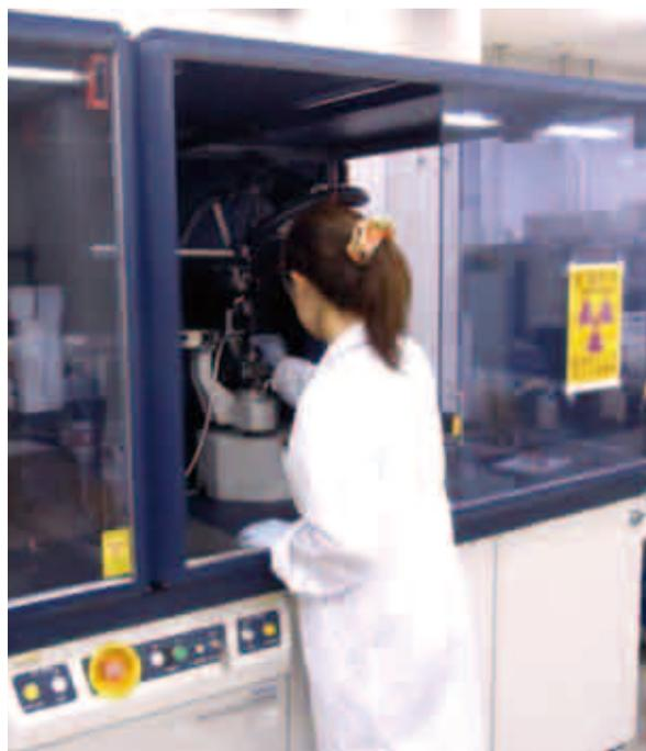
図2 X線回折装置の写真
