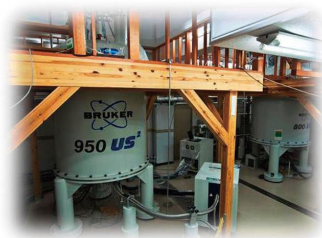
溶液 950 MHz および 800 MHz NMR 装置
