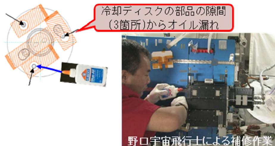
Fig. 13 野口宇宙飛行士による軌道上補修作業の様子
