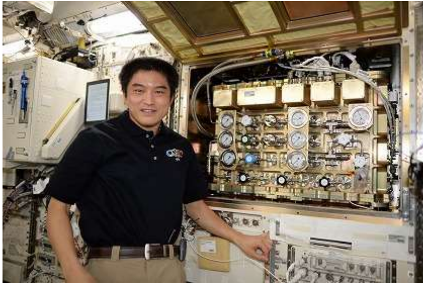
図 3. 6-3 多目的実験ラック (MSPR) のワークボリュームへ設置された 燃焼実験チャンバ (CCE)
