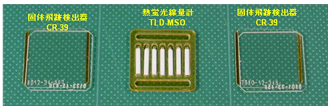
図 2.3-1 PADLES ドシメーターパッケージを構成する素子 (CR-39、TLD)
