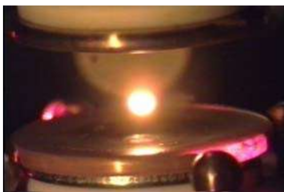
図 3.5-1 地上静電浮遊炉での浮遊と加熱
