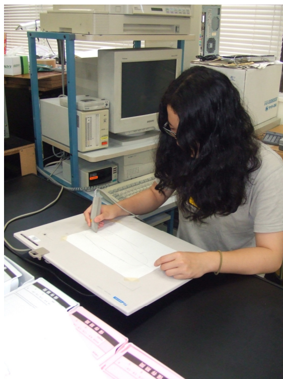
図1. デジタイザによる足型外郭投影図データ入力作業の様子
