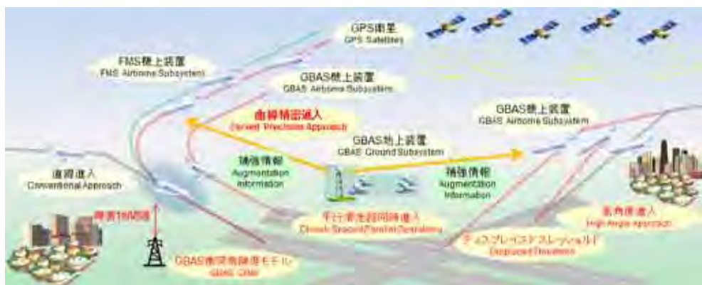
図 1.9 新しいGBASを使った着陸システム GLS の高度運用と従来の ILS による直線進入
