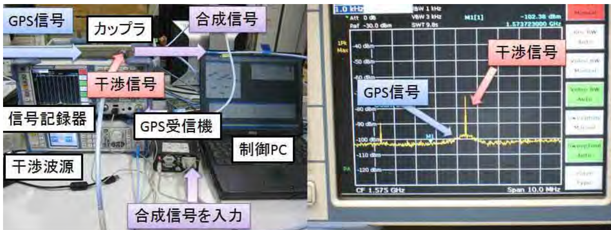
図 1.25 GPS 観測システムと疑似干渉波印加システム（右はスペクトラムアナライザ画面）
