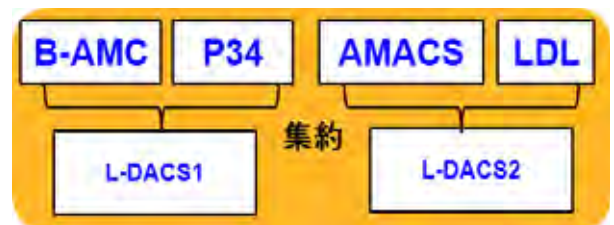
図 1.19 ICAO 欧米協調作業（Future Communications Study）における L-DACS システムの変遷
