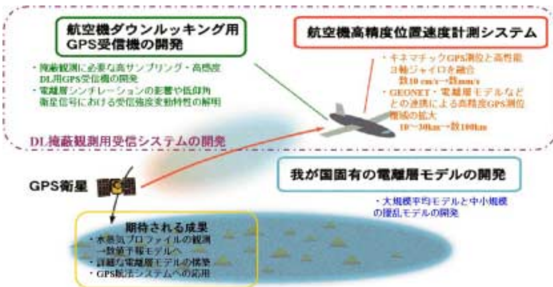
【 航空機のダウンルッキングGPS掩蔽観測技術の開発研究 概念図 】
