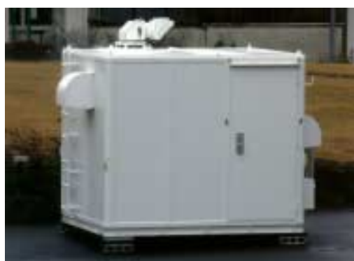
図 1 後方乱気流検出装置
