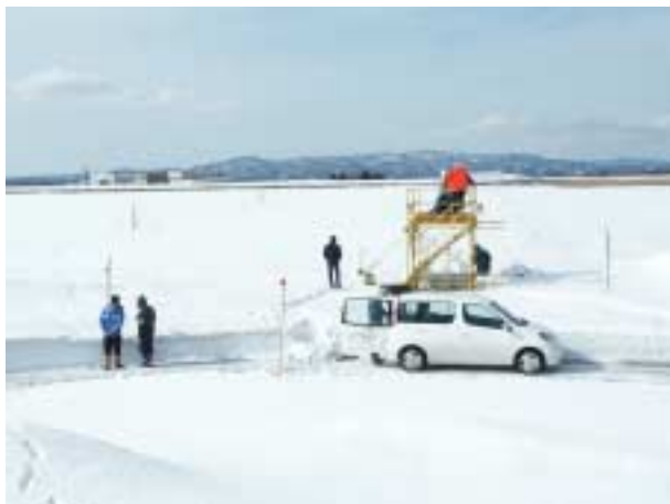
【 3次元レーザー・プロファイラによる積雪面計測状況 】
