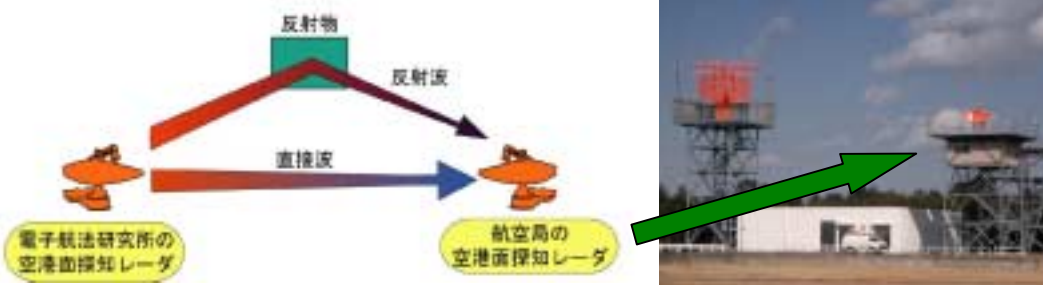
空港面探知レーダの複数設置のための電波干渉評価実験
