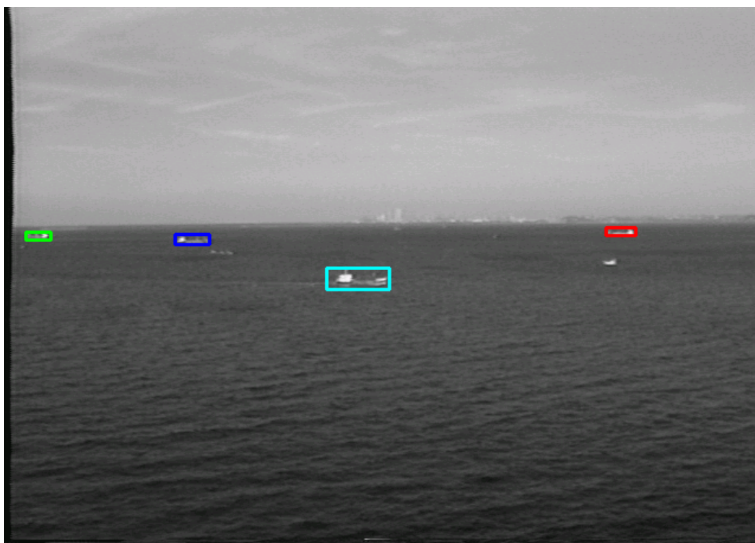
【図：個々の船舶のトラッキングを行っている例】
