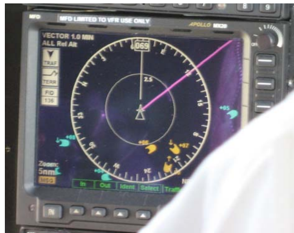
図 2.14 飛行実験時の「キャプストーン機上装置」の画面
