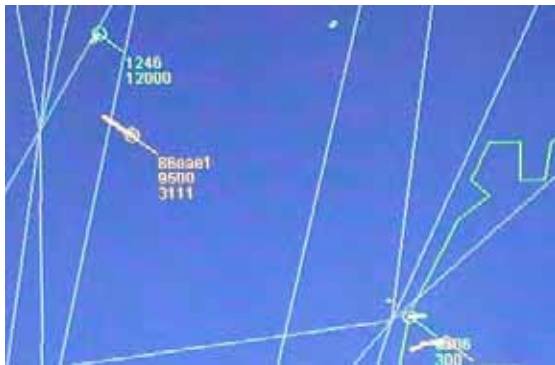
図2. 飛行実験中のSSR画面：山形上空を飛行する当所の実験用航空機(88eae1と表示)
