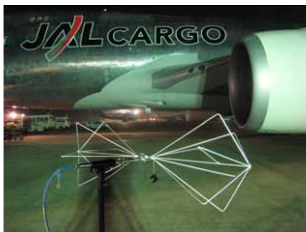
図 3 貨物機の機体シールド特性測定状況
