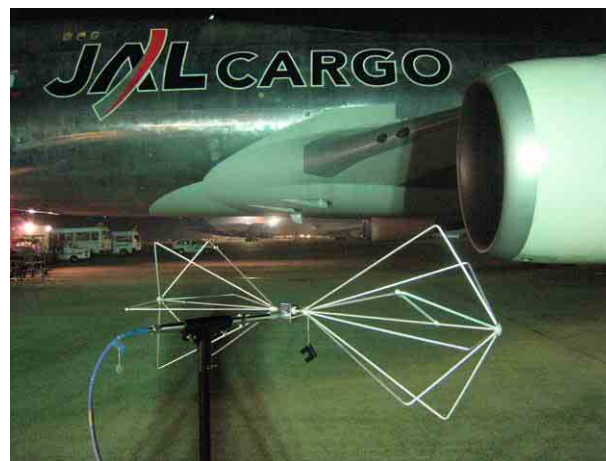
図 2.17 山形空港付近での機内電波環境（上図）、貨物機のシールド特性測定状況（下図）
