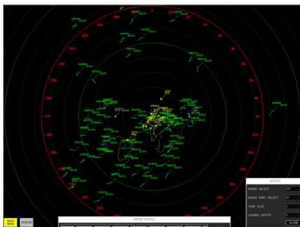
図 2.4 SSR モード S 実験局 (調布局) の空中線と装置群 (上段) 表示画面 (下段左)、データリンク能力通報の集計結果の一部
