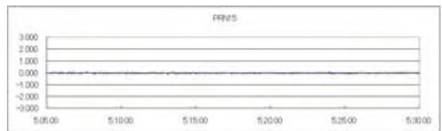
図-3 シミュレータによる50m離れた障害物からのL5信号に対するマルチパスによる誤差の実験結果
