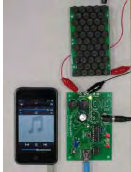
図 1: 実験システム送信部. 上の基板はパラメトリックスピーカ本体, 下の基板は駆動部, 左側は携帯型オーディオプレーヤ
