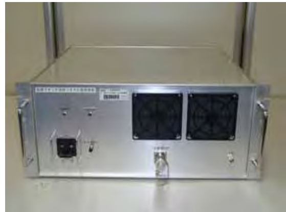
図 3. TIS-B 地上側送信装置 (拡張スキッタ送信システム高周波部) の外観図
