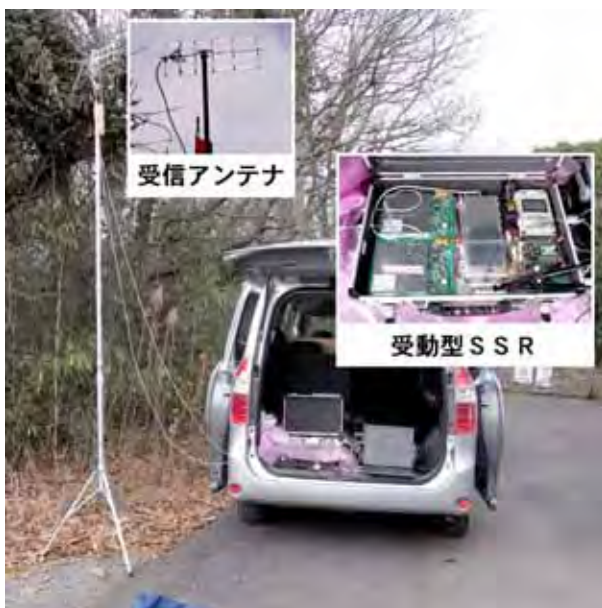
図 1 受動型 S S R の機能評価実験状況
