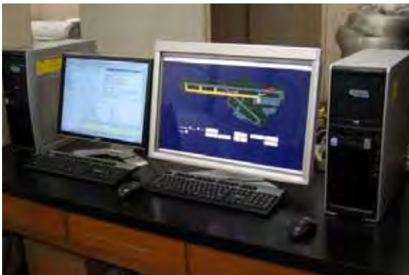
図6 タッチパネルを使った経路生成装置外観
