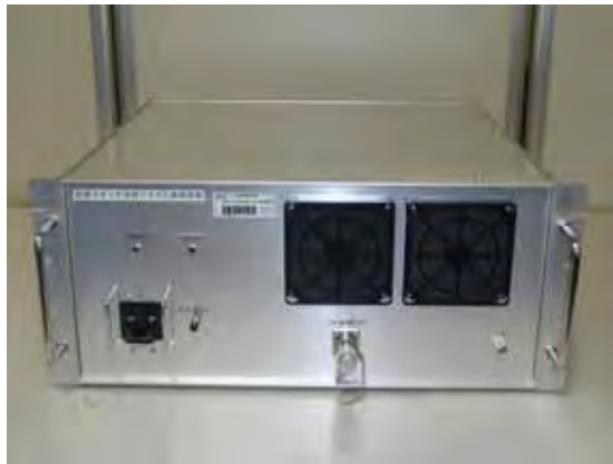
図 2.20 TIS-B 地上側送信装置（拡張スキッタ送信システム高周波部）の外観図
