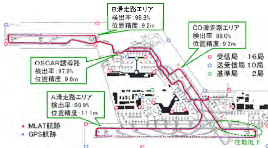
図 1 飛行検査機の試験航跡と評価エリア毎の性能値
