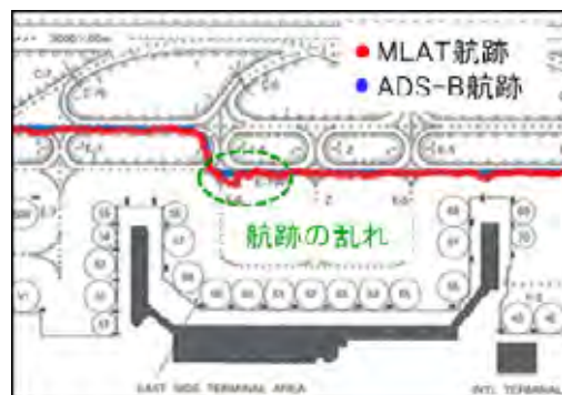
図4 両監視センサによる航跡例
