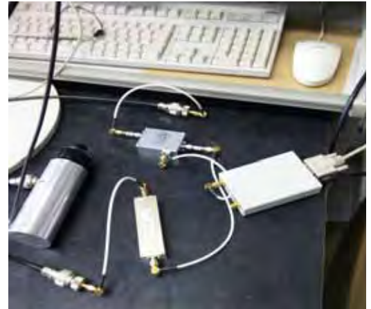
図 2.35 イメージ除去ミキサの試験中の様子
