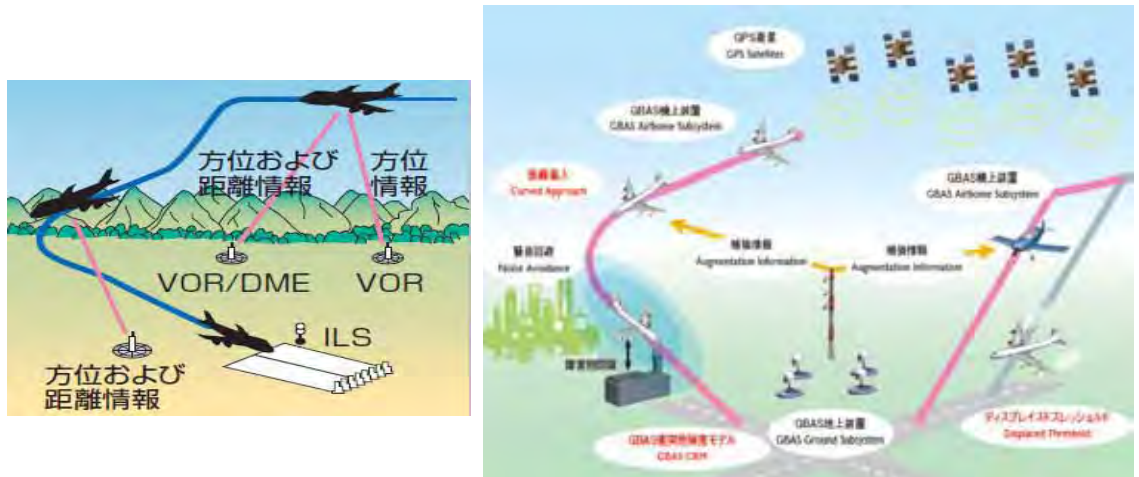
図 2.9 従来の着陸システム（ILS）と新しいGNSSを使った着陸システム（GLS）との比較 解説：左図に示された、現在の空港の ILS では、地上施設に依存しており、予め定められたルートでの進入を行う必要があることから、空港渋滞の主な原因となっている。右図の GLS の利用により、広い範囲に曲線を含む経路の設定が可能となり、住宅地から離れた経路の設定により、騒音影響の軽減が可能。また、山岳を避けた経路設定により、安全性向上、空港容量増加の効果が得られる。
