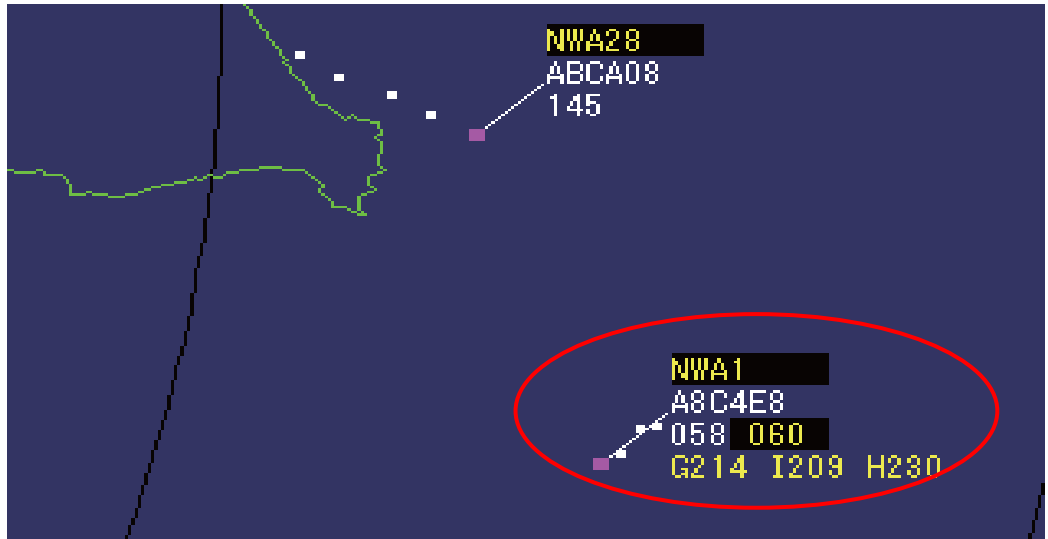
図 2.2 本研究により開発した、動態情報取得可能な SSR モード S 装置による実例
