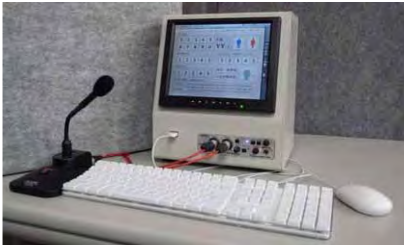
図 2.29 小型化した発話音声分析装置
