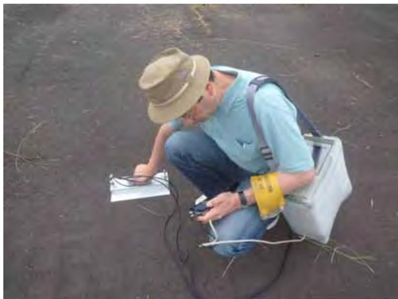
図 2.19 誘電率測定装置による ILS GP モニタ反射板誘電率測定風景
