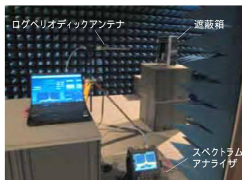
【CFRP 遮蔽量測定状況】
