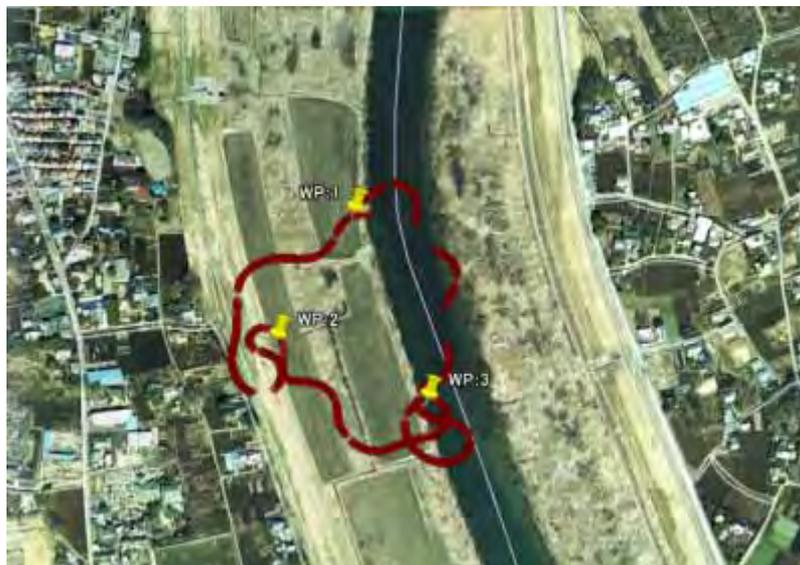
図 2.27 3次元自律飛行制御実験における指示通過点（黄色）と実際の経路（赤）
