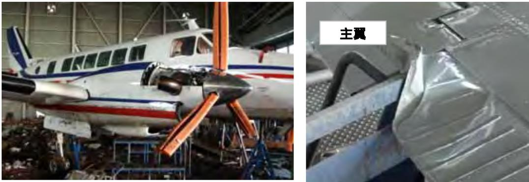
図 5.1 実験用航空機の被災状況
