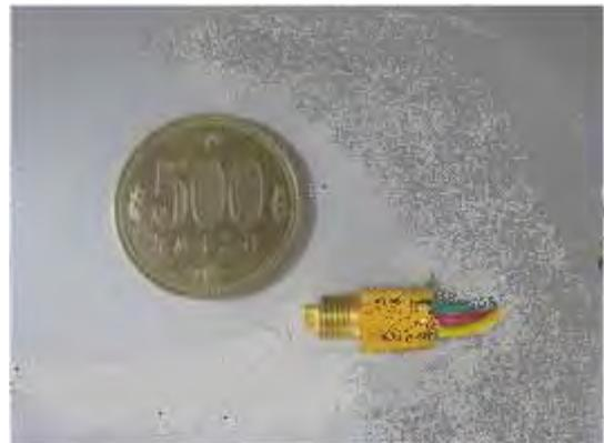
図 2.44 超小型ミリ波無線回路
