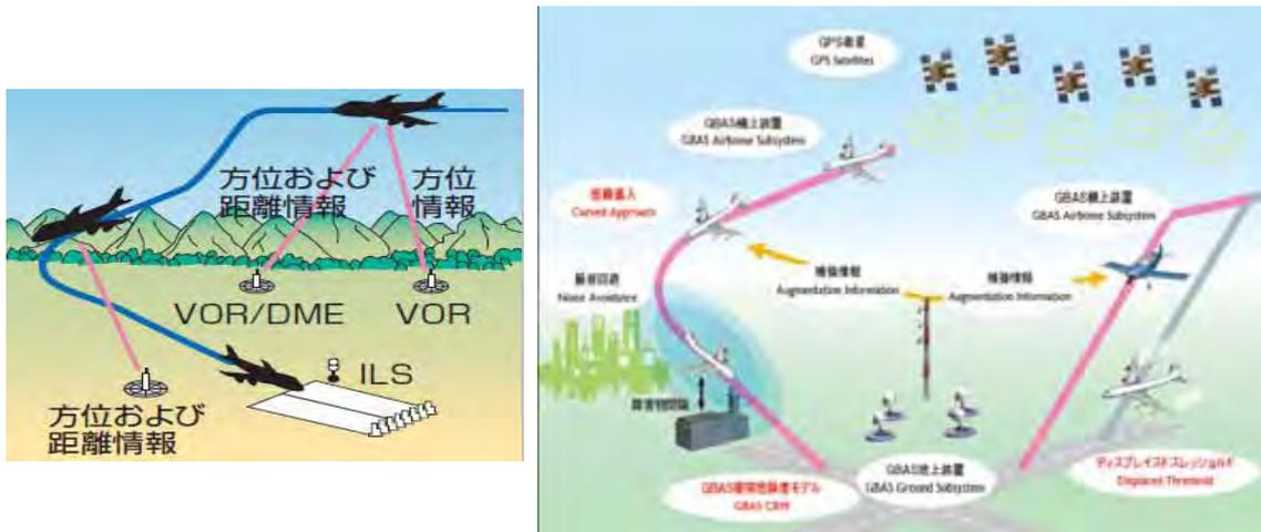
図 2.8 従来の着陸システム（ILS）と新しい GNSS を使った着陸システム（GLS）との比較
