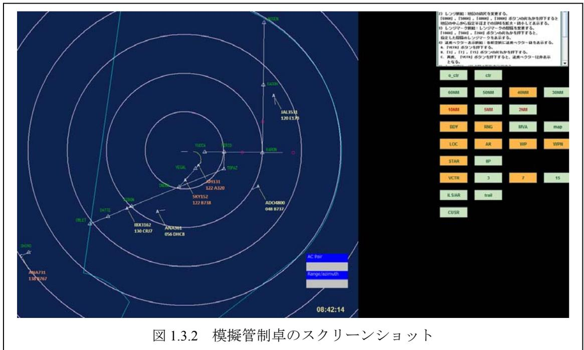
昨年度までに作成したシミュレータプログラムを改修し、機種毎の高度／速度プロファイルに対応させ、再生機能等を追加した。昨年度に実施したリアルタイムシミュレーション実験にて得られた知見等を考慮した条件にて仙台空港ベースの模擬空域（実測速度・高度プロファイルを反映）にて実験を実施した。Safety Case の作成に必要な潜在的異常接近の検知に関する実験も実施した。
