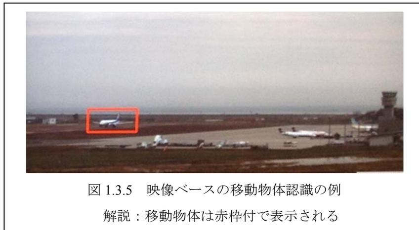
図 1.3.5 映像ベースの移動物体認識の例
