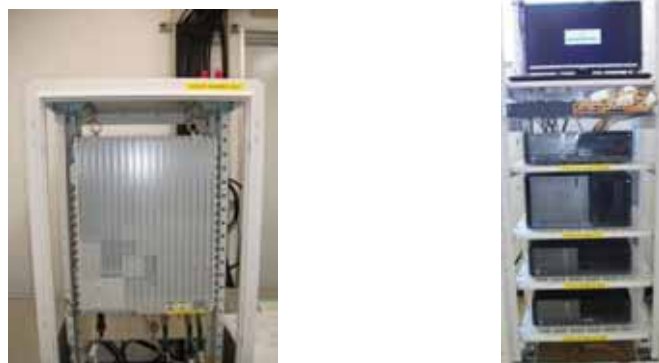
図 1.1.26 開発した AeroMACS プロトタイプ基地局 (左側機材) 及び AeroMACS プロトタイプサーバ類 (右側機材)
