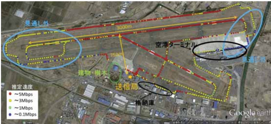
図 1.1.17 実験結果から推定される伝送速度
