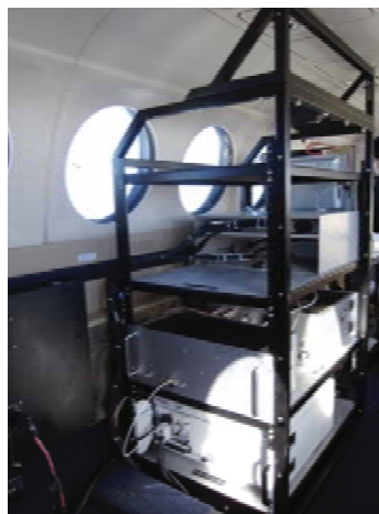
図 1.1.12 新しい実験用航空機に搭載した信号環境測定実験機器
