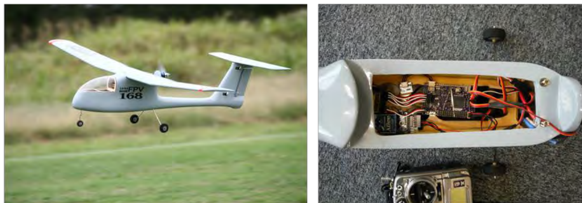
図 1.34 左図：構成した機体（全長 1190mm 翼端 1660mm） 右図：自律制御装置
