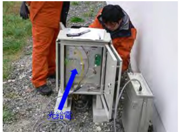
図 1.11 光給電方式を実装した受信部の外観
