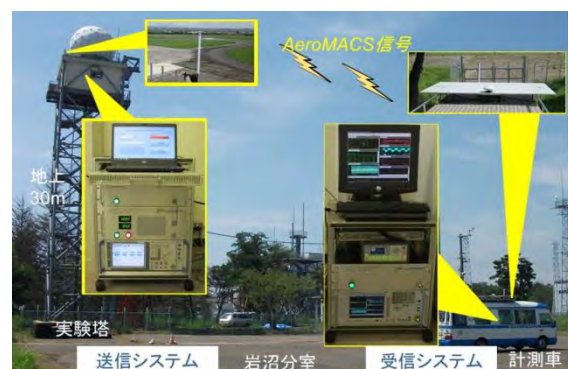
図 1.23 AeroMACS 信号実験システム
