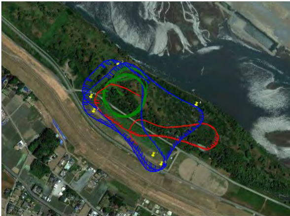
図 1.35 自律制御による飛行軌跡 (青：ウェイポイント飛行、緑：旋回飛行)
