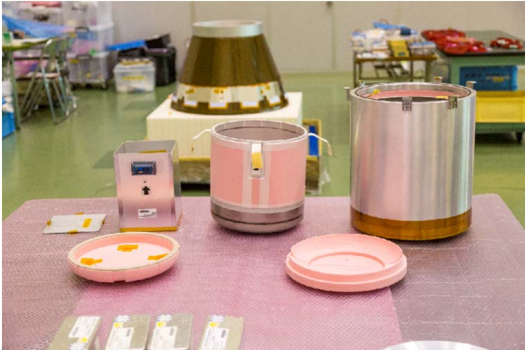
図 6.1-4 HTV 搭載小型回収カプセルと試料収納部の構成（JAXA）
