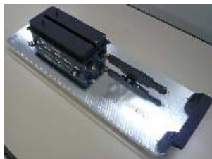
ISS 接近用の通信機器（シグナス8号機まで採用）
