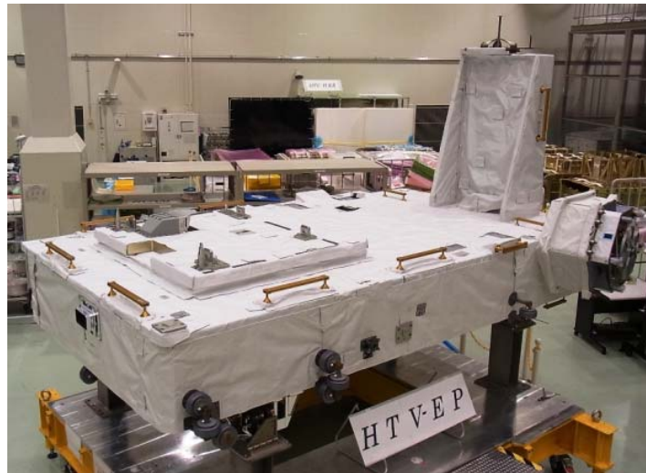
図A1.3-1（1/2） 曝露パレット（3号機用のEP-MP）（JAXA）
