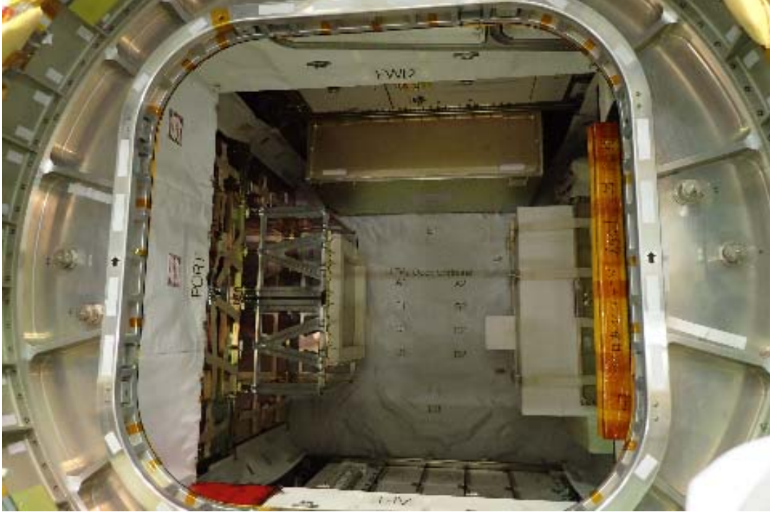
図A1.1-3 「こうのとり」7号機内部のラック配置（JAXA）
