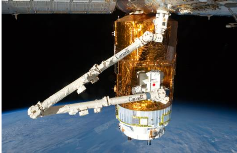
ISSのロボットアームで、曝露パレットを補給キャリア非与圧部から取り出す写真（3号機）（NASA）
