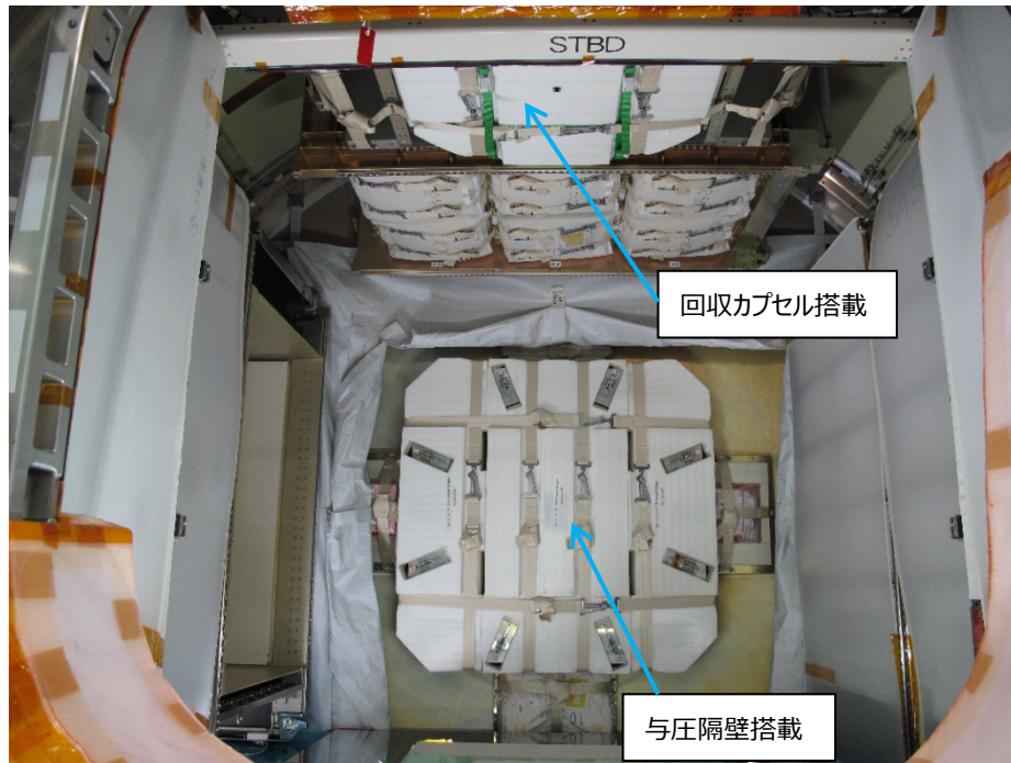
図 6.1-7 打ち上げ時の HTV 搭載小型回収カプセルの搭載場所（JAXA）
