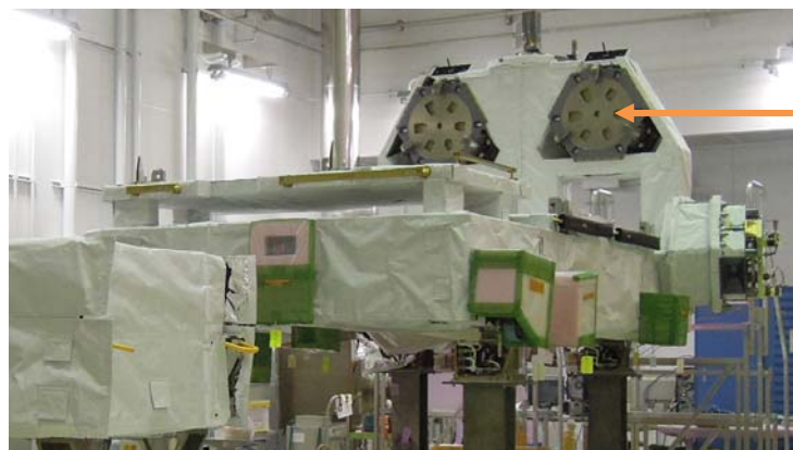
図A1.3-1（2/2） 曝露パレット（5号機用のEP）（JAXA）
