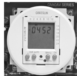
Controles del temporizador digital del GM40AVE
