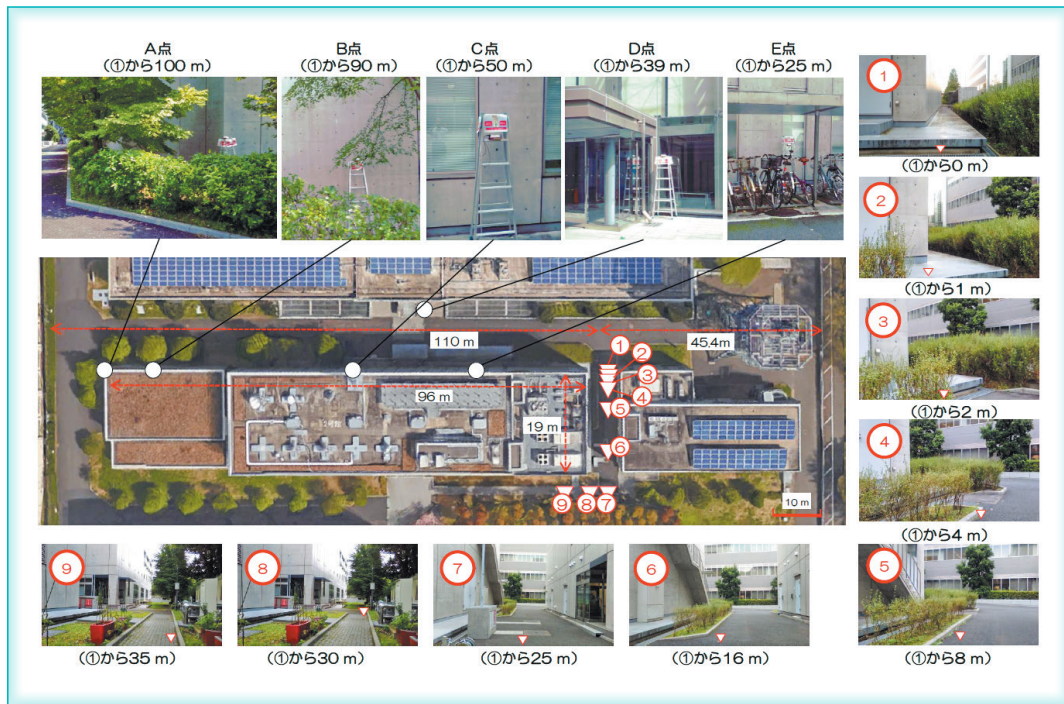
図7 Wi-SUN ビーコン RSSI 特性測定環境（見通し外）
