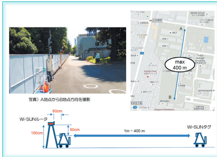
図5 Wi-SUN ビーコン RSSI 特性測定環境（見通し）
