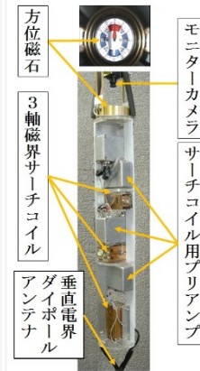
図1. 地中ボアホール内挿入用3軸磁界及び垂直電界検出センサーシステム
