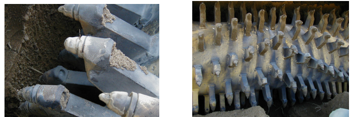
写真 7 ビット欠損・抜け落ち
