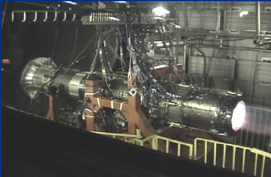
エンジン地上運転場搭載状況 (アフターバーナー試験)
