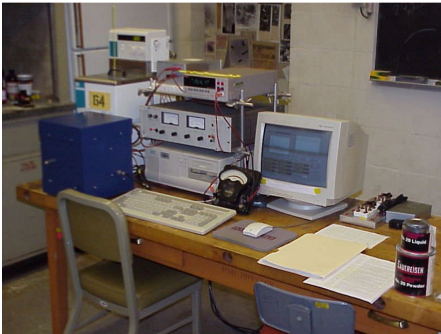
Figura 1.9. Uma experiência típica de fusão a frio, na caixa azul um calorímetro Seebeck à esquerda. From J. Dash, Portland State University. Fotografias por Dan Chicea, cortesia de B. Zimmerman. Este calorímetro custa US$6,000. A maioria das experiências custam cerca de $50,000 incluindo todo equipamento, e funcionam com voluntários e professores aposentados. Alguns produziram de 50 a 300 megajoules de uma vez. Conseguiram dois objetivos onde a fusão a quente falhou depois de 60 anos: Continuidade e ignição completa.
