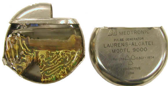
Figura 2.2. Marca-passo a plutônio. O plutônio foi removido; se coloca no entalhe do topo à esquerda. Centenas destes foram implantados em pacientes doentes do coração. A fusão a frio também se reduz em dispositivos deste tamanho ou menores e pode se agrandar a qualquer tamanho.
