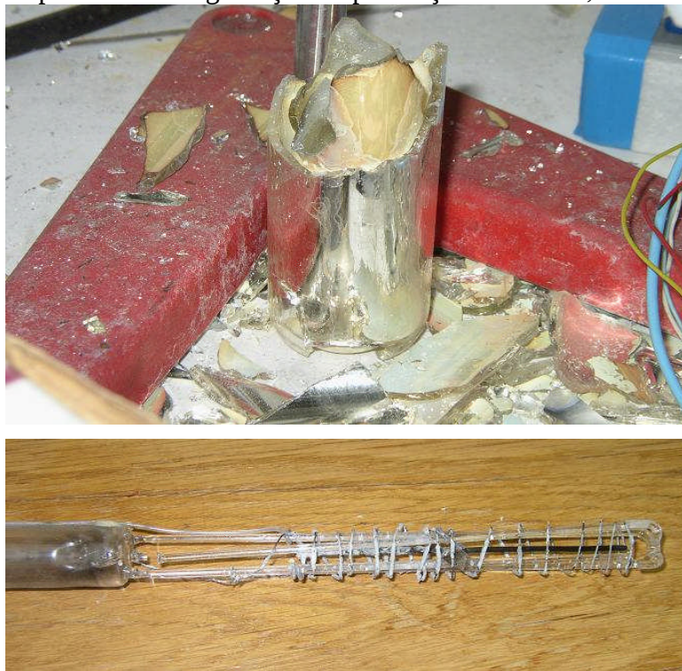
Figura 12.2. Os restos de uma célula que explodiu em Setembro de 2004, na Université d'Aix-Marseille II. Photo courtesy J-P. Biberian.
