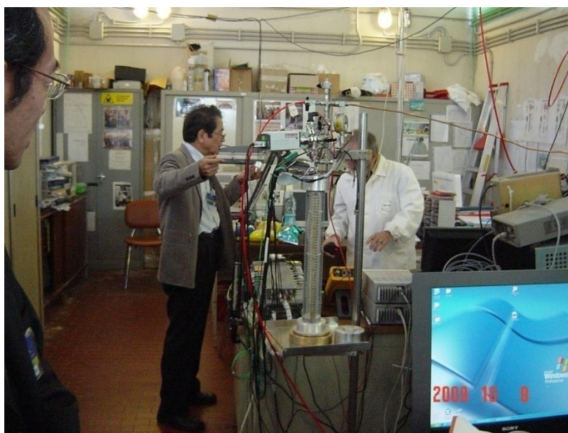
写真-7 Celani のミクロン Pd ワイヤーによる発熱実験装置
