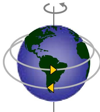
ビデオで山に風がぶつかる映像が登場します。風が西から東へ吹いて、山にぶつかる場合を考えてみましょう。ぶつかった風はその分勢いを失って速度をゆるめます。風の角運動量が減ります。一方山(固体地球)は風に押された分加速され、角運動量がわずかに増えます。こういった作用・反作用を通じて地球上のあらゆるもののが互いに角運動量をやりとりしているのです。ビデオではVLBIで測られた地球(の固体部分)の回転速度の変化と、気象学的に測定された世界中の風が持つ角運動量の変化が対比されます。それらは別の物の回転を別の方法で観測したものなのにそっくりな変化を示しており、この考え方の正しいことを示しています。宇宙からみた大気は地球の外側をはかなげに薄い層に過ぎません。その大気が地球本体の自転速度をコントロールするなんて「不思議の星」の面目躍如といえるでしょう。
