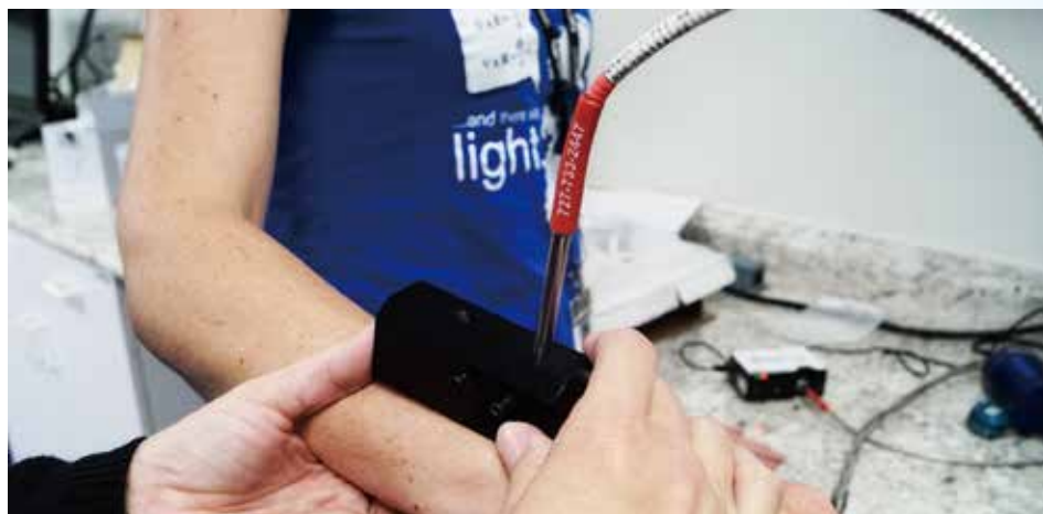
図1：ホルダに差し込んだ光ファイバプローブを用いて様々な対象者の皮膚の反射測定を行った。
