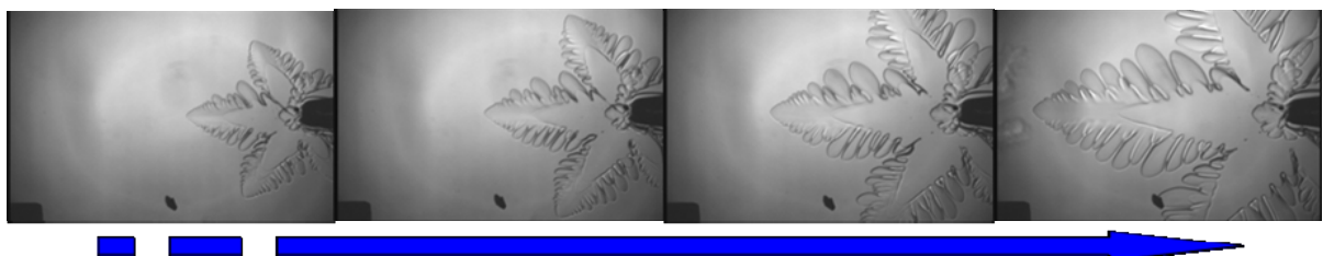
図 15 氷結晶成長実験における氷結晶成長の様子
