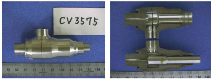
図 1.1.5-5 減圧弁のボディの外観（調査報告書 P847 より引用）
